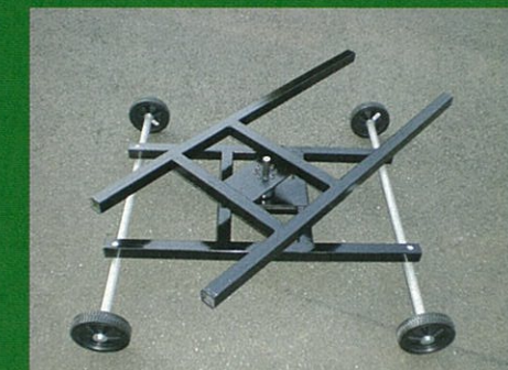
Unter- und Obergestell montiert
